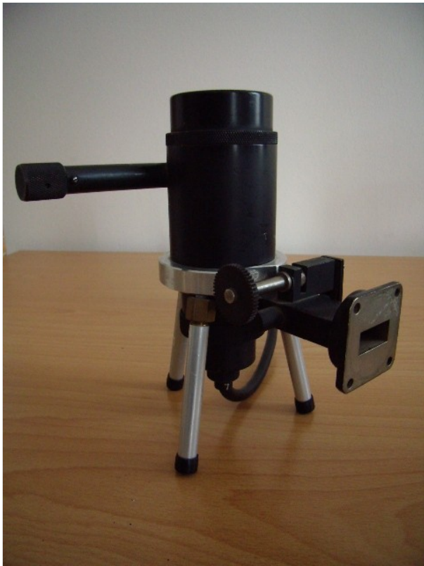
9GHz Klystron mit WR90 HL-Ausgang
