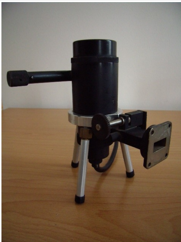
9GHz Klystron mit WR90 HL-Ausgang
