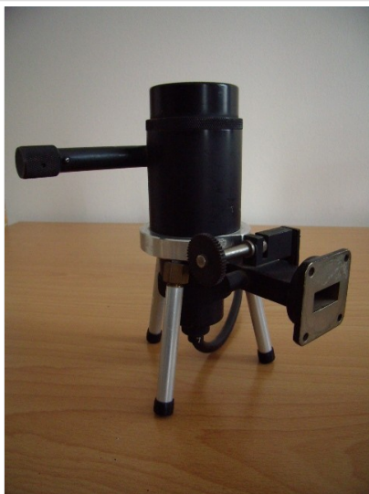
9GHz Klystron mit WR90 HL-Ausgang
