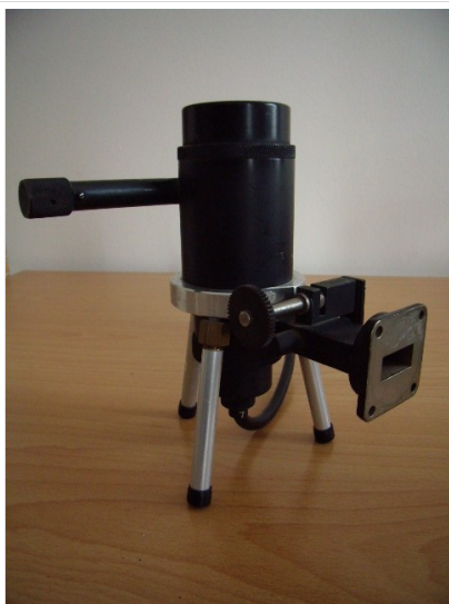
9GHz Klystron mit WR90 HL-Ausgang
