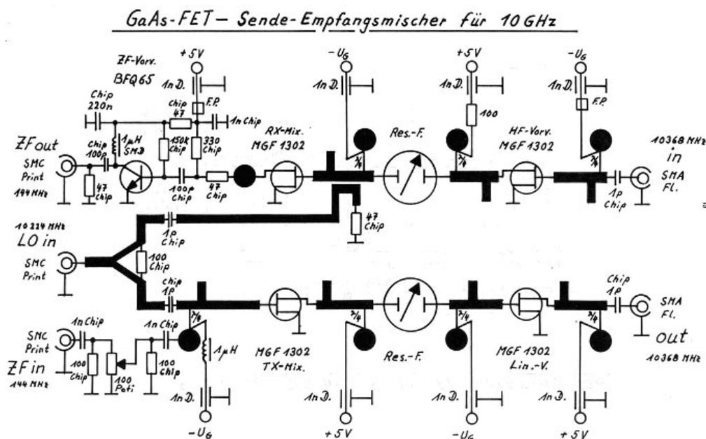
1992 beschrieb Peter Vogl, DL1RQ anlässlich der VHF-UHF-Tagung in München einen dritten Transverter, der mit einer Zwischenfrequenz im 70 cm-Band arbeitete und mit Microstripline-Filter ausgeführt war.
