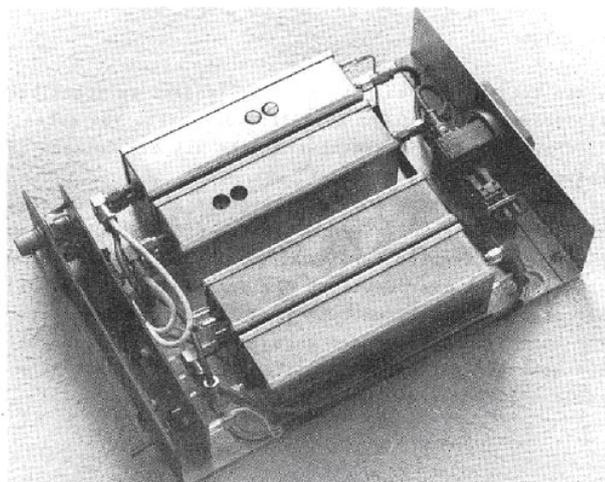
1988 beschrieb Jürgen Dahms, DC0DA, anlässlich der VHF-UHF-Tagung in München einen 10 GHz-Transverter, der auch als "Portable-Simple" bezeichnet wurde. Wie der Name schon verrät, ist die Schaltung sehr einfach gehalten und als Einstiegsprojekt für 10 GHz geeignet.
