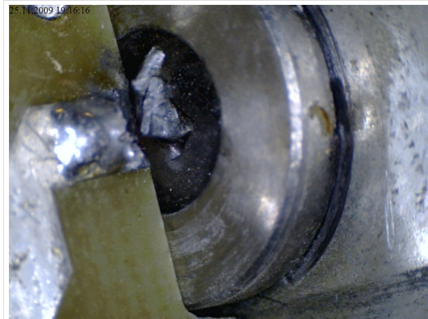
Überdrehte und durch Fibrationen am Mast abgebrochene F-Buchse
