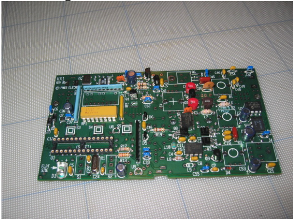
Hauptplatine mit alle niedrigen Teilen
