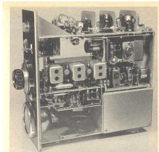
Bild 88. Innenaussicht der 2-m-Station von DL9AL mit Zf-Baustein
