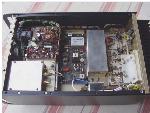
Neukonstruktion des SSB/FM-2m-Transceivers aus SEMCO-Bausteinen
