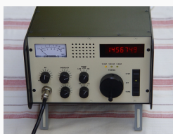
Neukonstruktion DK4SX, mit Umschalter FM/SSB und Relaisablage
