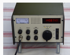
Neukonstruktion DK4SX, mit Umschalter FM/SSB und Relaisablage
