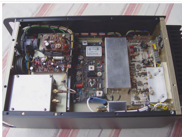
Neukonstruktion des SSB/FM-2m-Transceivers aus SEMCO-Bausteinen
