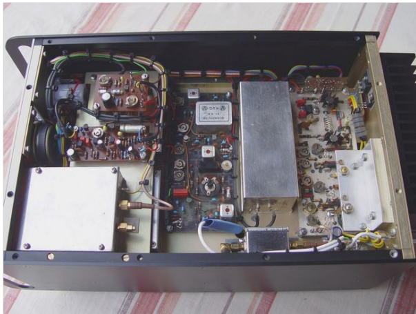
Neukonstruktion des SSB/FM-2m-Transceivers aus SEMCO-Bausteinen
