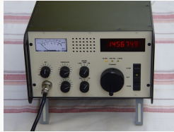
Neukonstruktion DK4SX, mit Umschalter FM/SSB und Relaisablage
