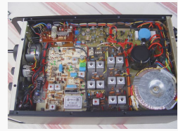
Blick unter das Chassis: Empfänger mit Frontend, ZF, Netzteil mit Ringkerntrafo, NF Verstärker auf dem FM Demodulator
