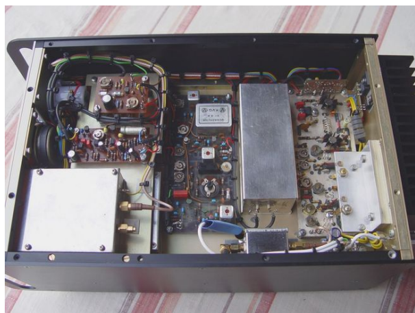
Neukonstruktion des SSB/FM-2m- Transceivers aus SEMCO-Bausteinen
