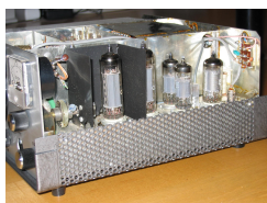
Detailansicht der Endstufe
