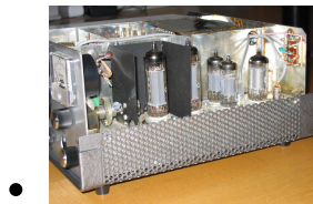
Detailansicht der Endstufe
