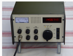
Neukonstruktion DK4SX, mit Umschalter FM/SSB und Relaisablage
