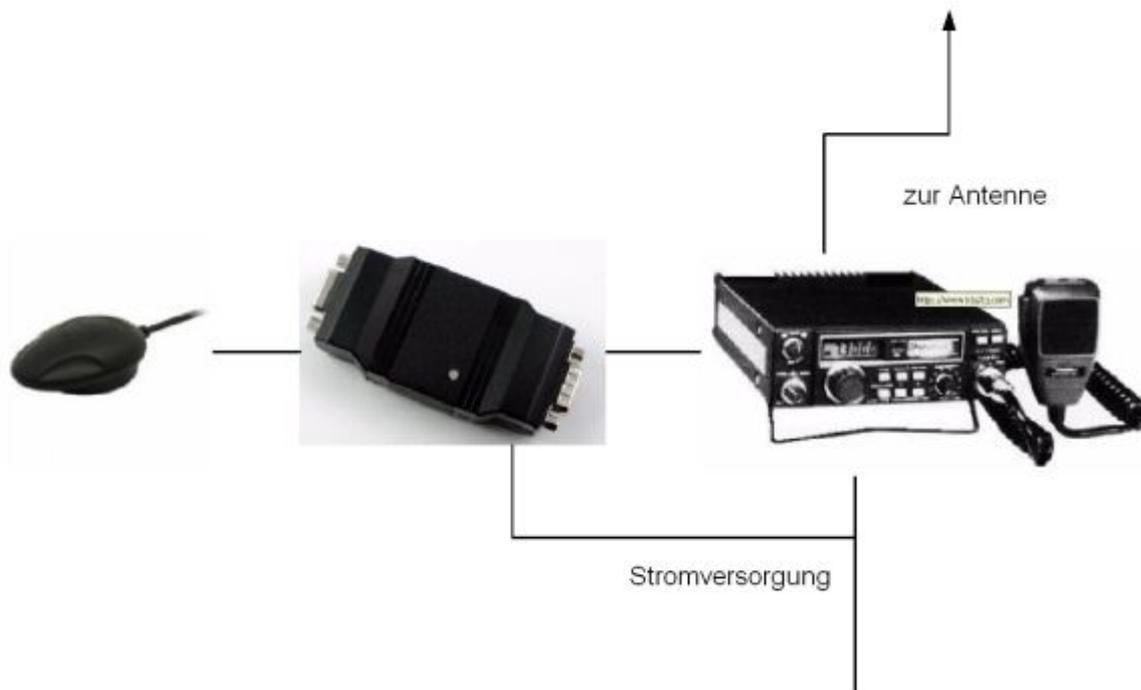
Wer Bauteile und Budget sparen möchte, kann sich auch den [DXL - APRStracker](#) zusammenlöten, in der minimalsten Form mit nur etwa 10 Bauteilen ist man schon fast QRV in APRS.
