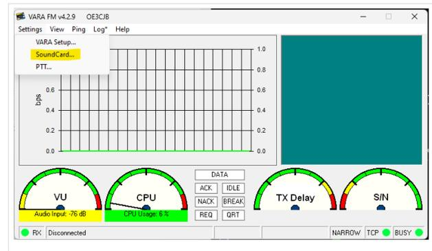
Den "Drive level" = Ausgangssignal der Soundkarte stelle ich für den Start in die Mitte.
