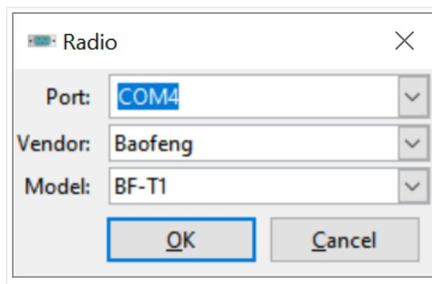
Der Port ist je nach Windows-Konfiguration unterschiedlich, ggf. im Windows-Gerätemanager nachsehen oder die angebotenen Ports durchprobieren. Die Verbindung ist nicht besonders robust, ggf. Gerät ausschalten, Kabel neu anstecken und vor der Datenübertragung einschalten.
