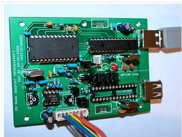
hier die Platine von der Bestückungsseite. Der große Chip links ist der GSM Modemchip welcher das D-Star Signal erzeugt welches dann vom Transceiver digital ausgesandt wird.
