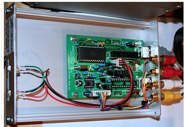
Die Steckverbindungen haben ich alle mit Chinch Buchsen ausgeführt. So ist man flexibel und kann schnell verschiedene Geräte umstecken ohne neue Kabel löten zu müssen.
