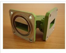
Hohlleiter werden mittels Flansche verschraubt die an den Enden eines Hohlleiters aufgelötet werden. Nachdem die (rechteckigen) Hohlleiterrohre starr sind, können Richtungsänderungen in H oder E-Ebene nur durch vorgefertigte Bögen, Twiste oder flexible Hohlleiter vorgenommen werden. Als Ausnahme sind
