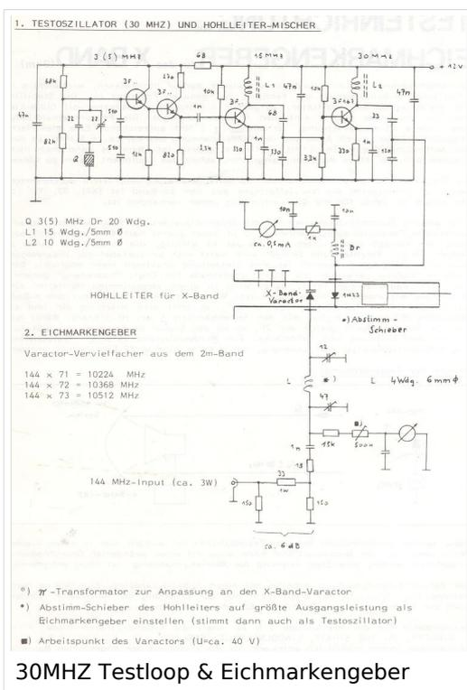
Eine weiteres Hilfsmittel war die 30MHz Testloop Einrichtung, die auch in der kommerziellen Richtfunktechnik, jedoch für eine ZF von 70MHz verwendet wurde. Damit konnte man ohne Gegenstation das ausgesendetes HF Signal wieder rück-empfangen und damit vor allem die Modulationseigenschaften überprüfen.
