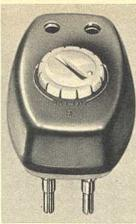
**Rechts: Bild 9.** Einsteckbarer Dämpfungsteller, einstellbare Dämpfung von 0 bis 20 dB, Eingang und Ausgang 240  $\Omega$
