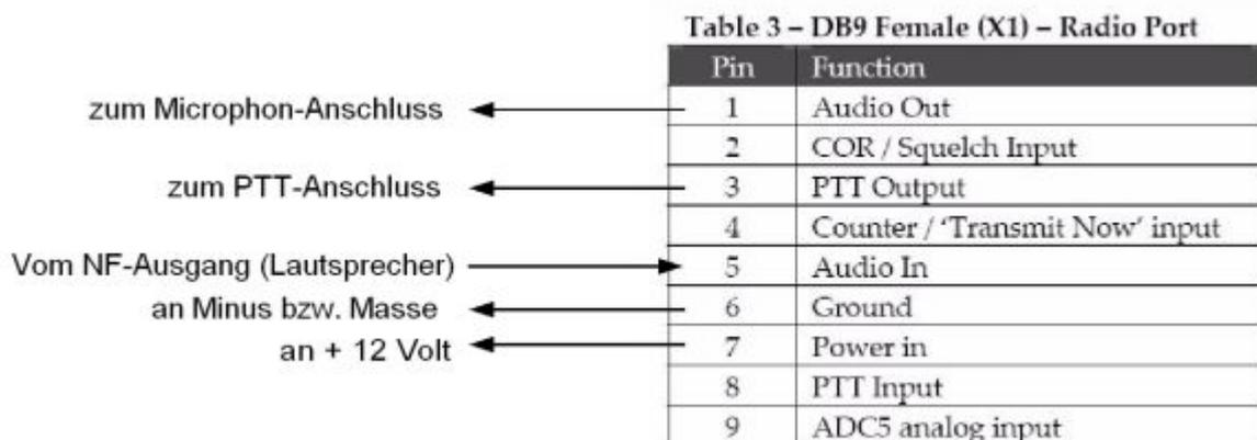
Für die „Kanal belegt“ Auswertung des OpenTracker+ (DCD) nutzt man entweder einen NF-Ausgang des Funkgerätes mit fixem Pegel, sonst halt den Lautsprecherausgang (Und Lautstärkeregerler nach dem Einpegeln nicht mehr angreifen!).
