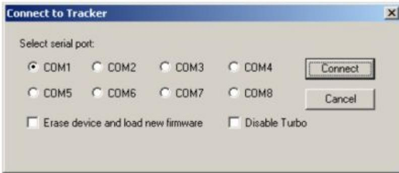
Im ersten Fenster muss man den seriellen Port am PC, an dem das Auskreuzkabel angesteckt ist, wählen. Nach kurzer Zeit meldet sich der OpenTracker und man sieht das Konfigurationsfenster:
