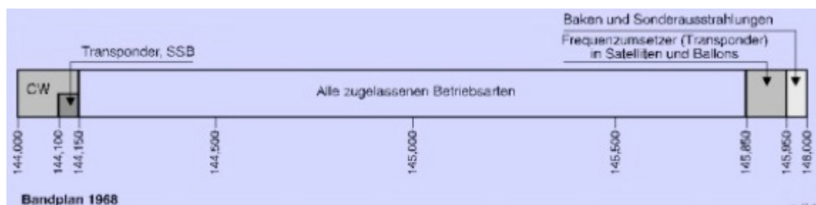
Bandplan für das 2 Meter Band 1968
