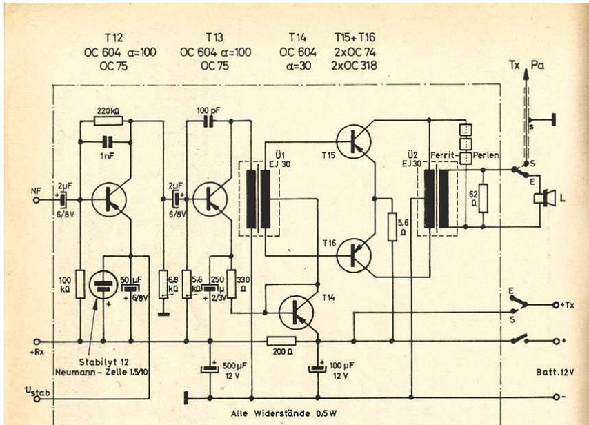
Abb.9: Modulator bzw. NF - Verstärker DL 6 SW (Schaltung)
