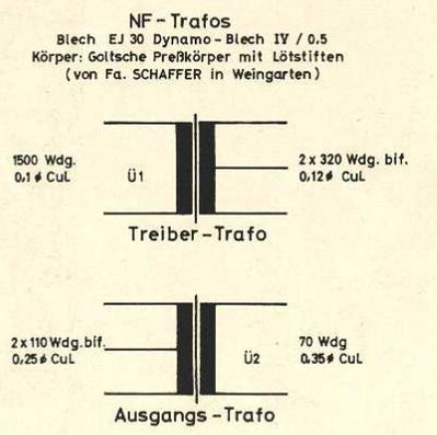
Abb.10: Übertrager für Modulator bzw. NF - Verstärker DL 6 SW
