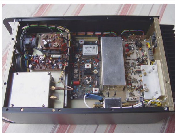
Neukonstruktion des SSB/FM-2m-Transceivers aus SEMCO-Bausteinen
