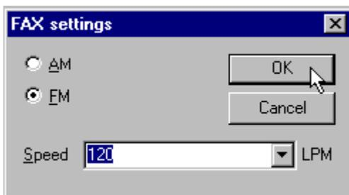
Die meisten Wetter-FAX-Stationen arbeiten mit 120 lines/min (Umdrehungsgeschwindigkeit der Trommel), dieser Wert muß aber mitunter korrigiert werden, um Abweichungen Ihres PC-Takts zu kompensieren. Gehen Sie über Mode > FAX zu Mode > Mode settings oder klicken Sie auf das FAX-Feld im Statusbalken. Jetzt können Sie den Wert für Linien/min (your lines/min) eingeben:
