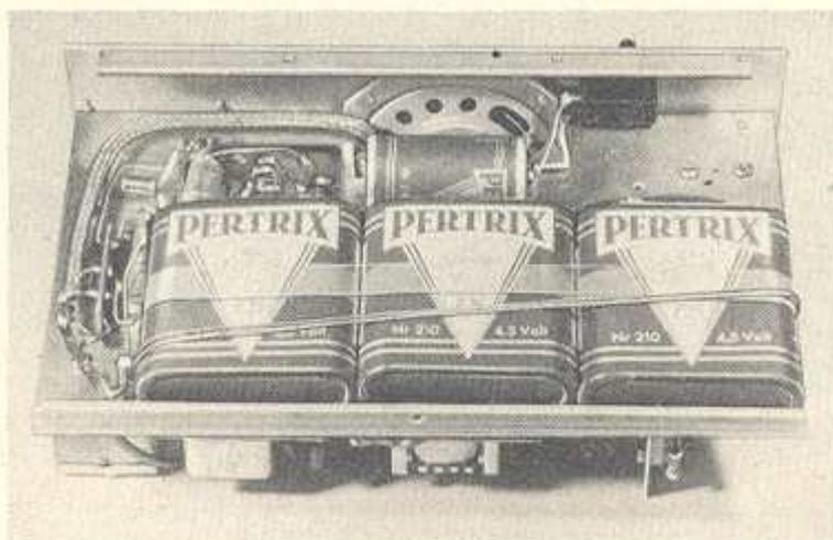
Bild 81. Unterbringung der Batterien unter dem Chassis
