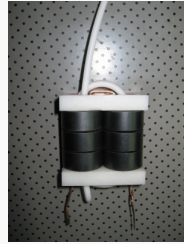
OE1IFM Aufbau Transformator
