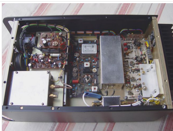
Neukonstruktion des SSB/FM-2m-Transceivers aus SEMCO-Bausteinen
