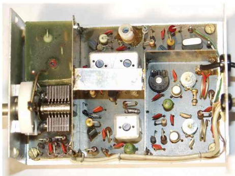
Abb. 1 Blick von oben in das Teko- -Gehäuse des 2 H 71 MO. Links auf der Platine die Kam- mer des VFOs, oben rechts der Festoszillator mit seinem Quarz. In der Mitte neben der Ab- schirmwand der Trimmer für die Output-Regelung, R 25, und C 30 für die Einstellung der Auskopp- lung. In der VFO-Kammer erkennt man deutlich die vergossenen, frequenzbestimmenden Teile so- wie den sehr stabilen Drehkon- densator.
