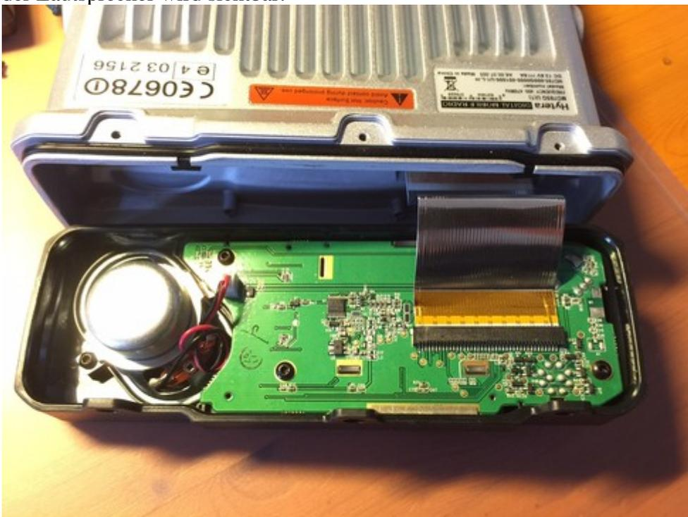
Im Gegensatz zu Volker bevorzugte ich den Einbau eines Trimpotentiometers, um bei der Einstellung variabel zu sein. Mit Hilfe des Trimm-Potis lässt sich nun, ganz nach Geschmack, das Verhältnis Komfortrauschen zu NF-Signal leicht einstellen:
