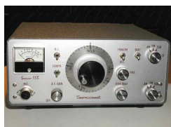
Originales SEMCO- SSB, getrennte FM /SSB Einstellung für TX und RX, BFO- Abstimmung. Alle Bilder: Uli, DK4SX
