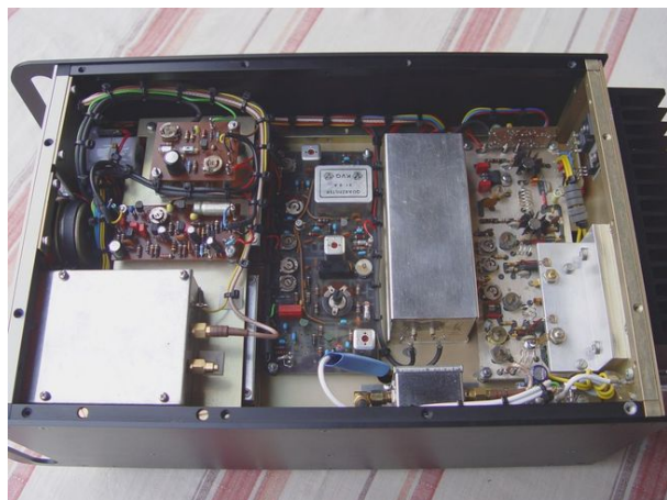
Neukonstruktion des SSB/FM-2m-Transceivers aus SEMCO-Bausteinen
