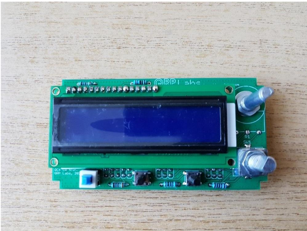
Wenn man dann eigentlich alles montiert hat und schon das Gerät einschalten will, sollte man sich noch die Zeit leisten und das Wichtigste tun – nämlich **alle Lötstellen mit der Lupe überprüfen**. Auch wenn man wirklich gut löten kann, bilden sich immer kleine Lötkekeln, welche Kurzschlüsse verursachen können und welche man am besten mit einer dünnen Nadel entfernen sollte. Die Lötbrücken am besten wegsaugen.
