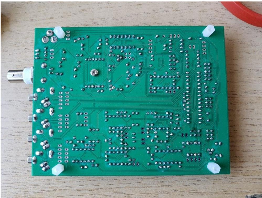
Nachdem ich nun beide Teile zusammengesteckt habe wurde die Kunstantenne angeschlossen. Vorher noch prüfen, dass zwischen + und - keine Verbindung ist. Das Netzgerät auf 11V gestellt und gehofft, dass der „Smoke Test“ gelingt.
