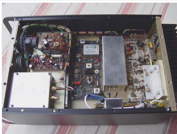
Neukonstruktion des SSB/FM-2m-Transceivers aus SEMCO-Bausteinen
