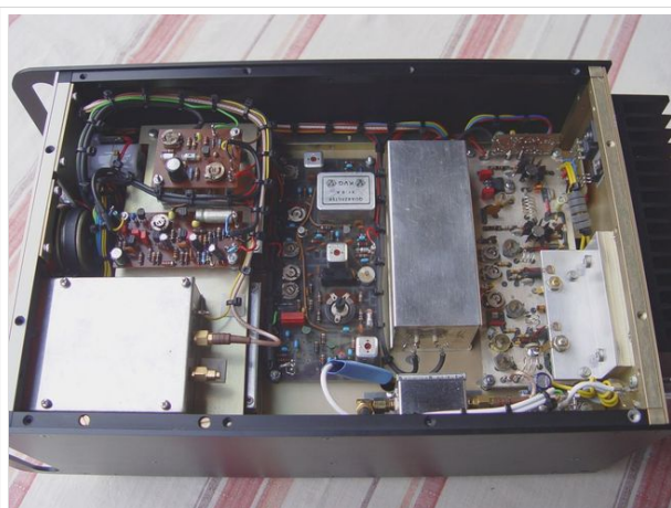
Neukonstruktion des SSB/FM-2m-Transceivers aus SEMCO-Bausteinen
