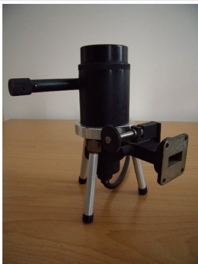
9GHz Klystron mit WR90 HL-Ausgang
