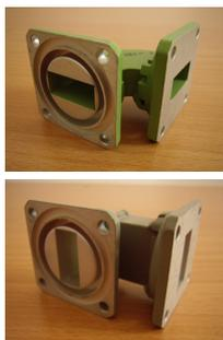
Hohlleiter werden mittels Flansche verschraubt die an den Enden eines Hohlleiters aufgelötet werden. Nachdem die (rechteckigen) Hohlleiterrohre starr sind, können Richtungsänderungen in H oder E-
