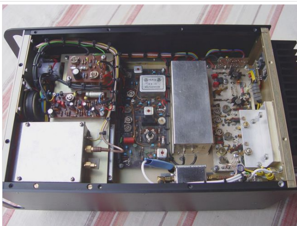
Neukonstruktion des SSB/FM-2m-Transceivers aus SEMCO-Bausteinen
