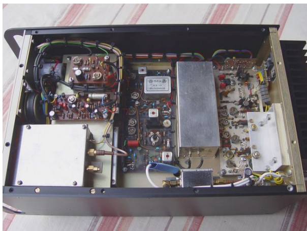
Neukonstruktion des SSB/FM-2m- Transceivers aus SEMCO-Bausteinen
