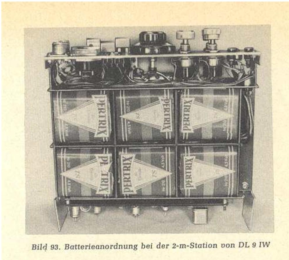
Bild 93. Batterieanordnung bei der 2-m-Station von DL 9 IW
