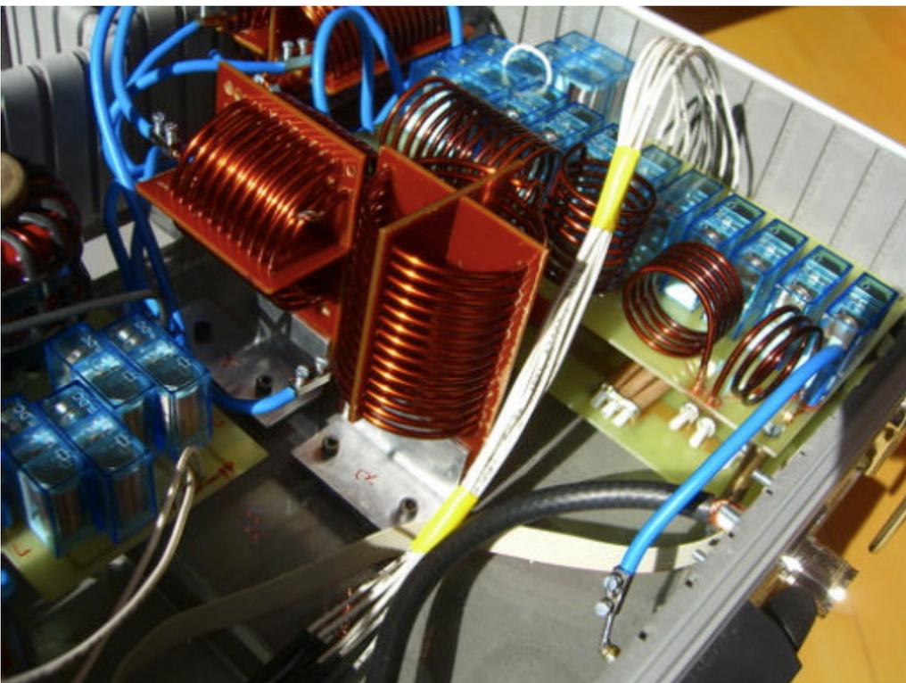
L/C Modul rechts mit L-Steuerstrang Verbindung zur linken Seite (weiße Kabel). Der CSteuerstrang wurde mit Flachbandkabel hergestellt (am Boden verlegt). Rechts im Bild die PL Buchse zum Anschluss an Transceiver bzw. PA.
