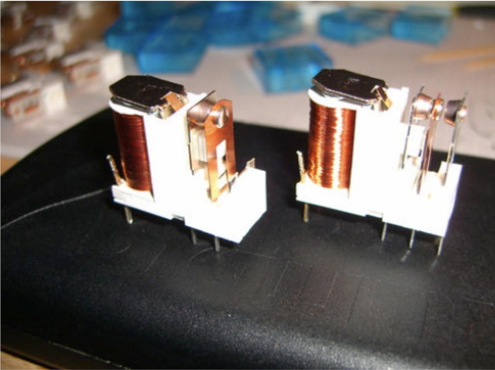
Die L-Relais wurden hinsichtlich des Kontaktdruckes modifiziert. Dazu wurde der Schließerkontakt entfernt und der Öffnerkontakt in Richtung Schaltkontakt gebogen
