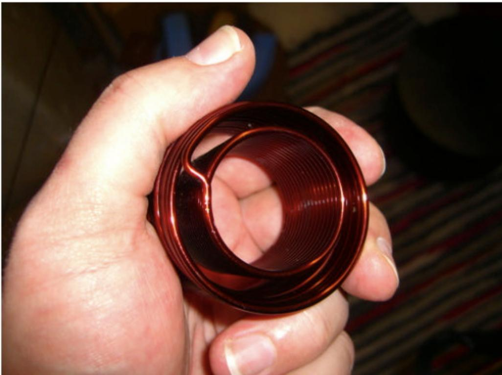
L7 fertig gewickelt. Zum Einfädeln in das Spulenkreuz muss der Verbindungssteg durchgetrennt werden.
