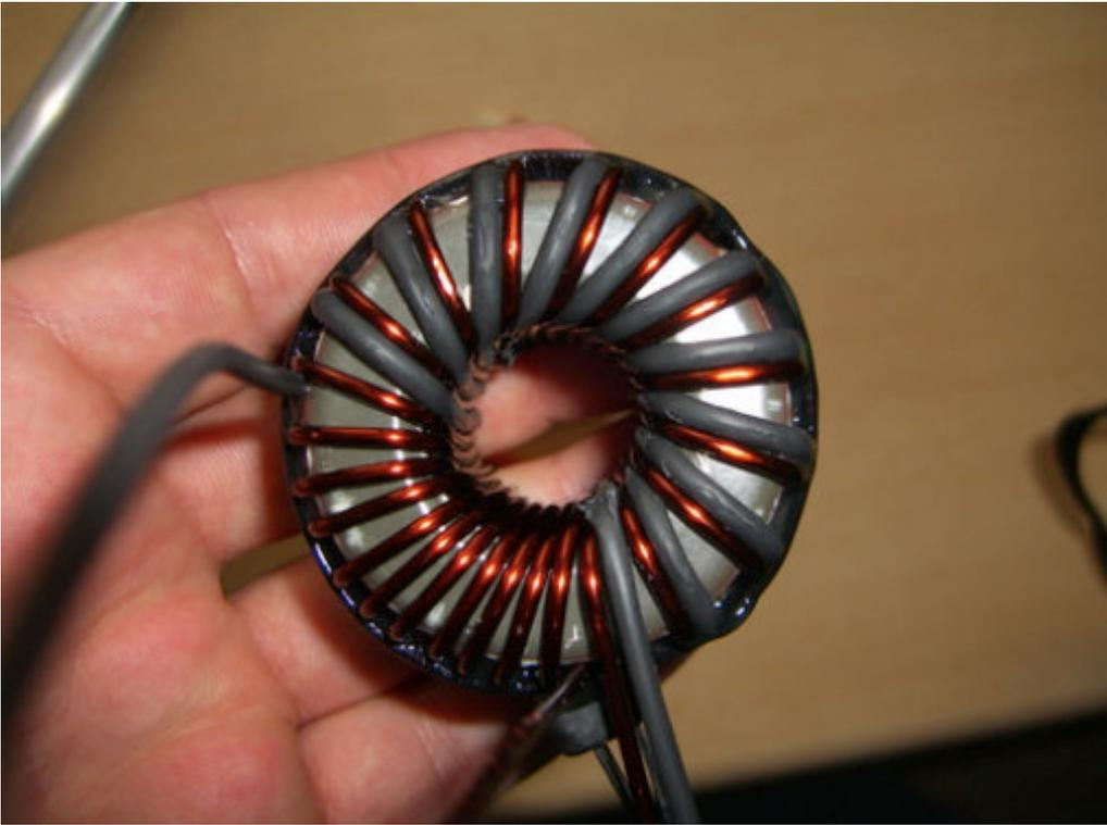
Der Balun fertig ohne Dorn. Zur Verbesserung des Isolationswiderstandes wurde eine Wicklung mit Schrumpfschlauch gefertigt. Der Schrumpfschlauch hat die ganze „Tortur“ allerdings nicht ohne Schäden überstanden
