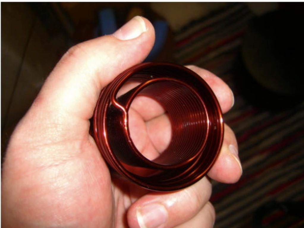
L7 fertig gewickelt. Zum Einfädeln in das Spulenkreuz muss der Verbindungssteg durchtrennt werden
