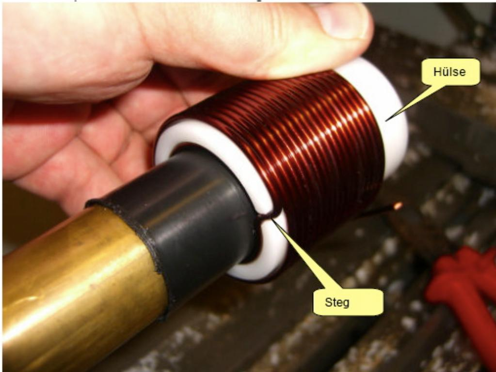
Auch das kann man selbst machen. Die Spulen habe ich aus 2.2mm Cu Draht gewickelt. Da in meinem Keller eine Drehmaschine steht war das nicht allzu schwierig. Nach der Herstellung des Dorn: war das eigentliche Wickeln keine Herausforderung. Für die doppelten Luftspulen war allerdings eine Hülse notwendig. Nun konnte ich mit vertretbarem Aufwand Spulensätze für mich und einige OM's aus dem Ortsverband herstellen.
