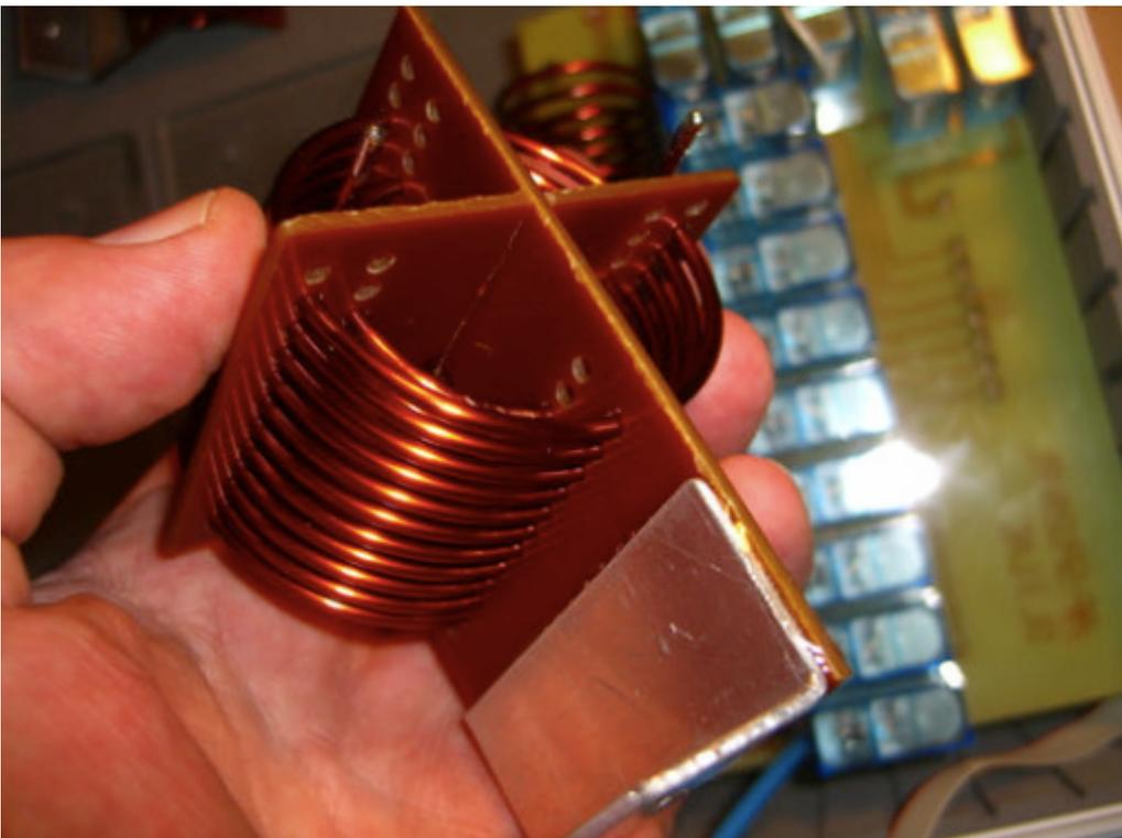
L6 Spulenkreuz fertig konfektioniert mit Montagewinkel (geklebt). Es hat sich gezeigt dass ein Bohrungsdurchmesser 2.5mm ideal für die Einbringung des Drahtes ist und der Spule trotzdem keine Raum zum Wackeln lässt.
