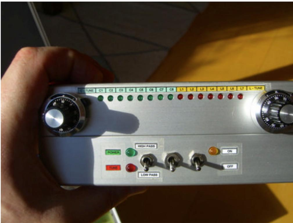
Das Steuergerät habe ich in einem formschönen Systemgehäuse untergebracht. Vorderseite, Schalter von Links nach Rechts: HP/TP - PA Verriegelung - Ein/Au
