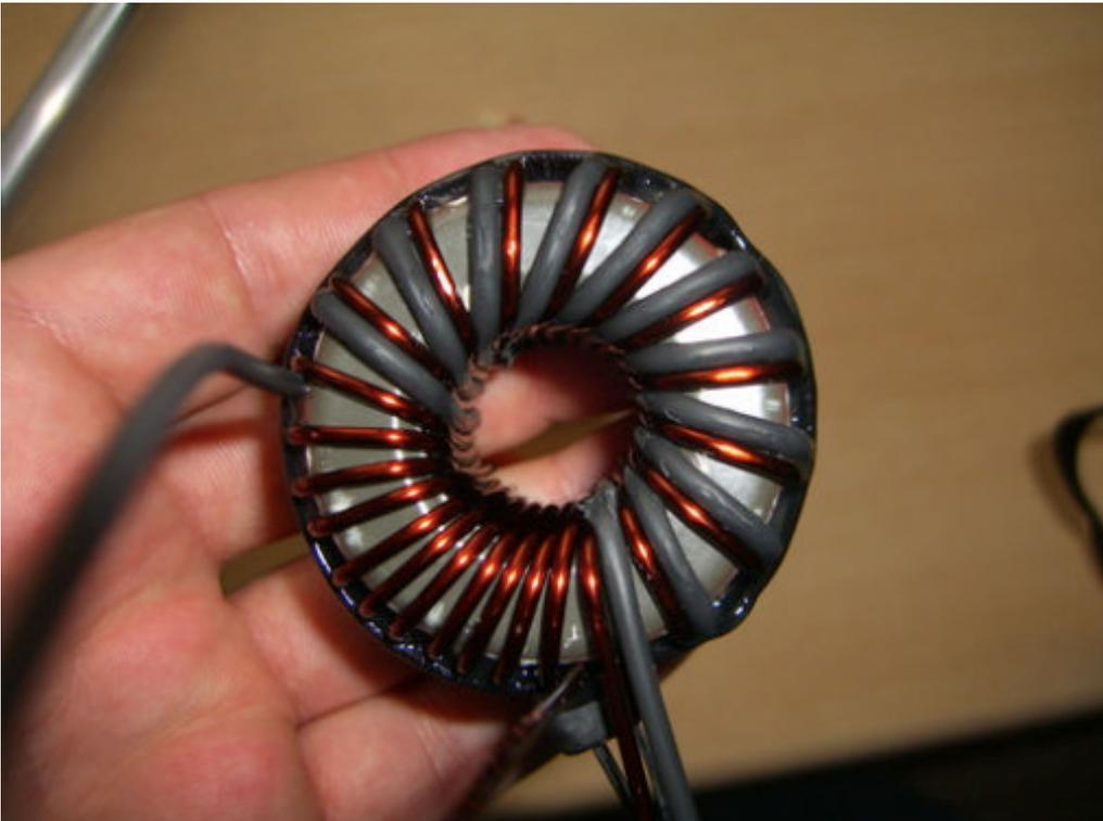
Der Balun fertig ohne Dorn. Zur Verbesserung des Isolationswiderstands wurde eine Wicklung mit Schrumpfschlauch gefertigt. Der Schrumpfschlauch hat die ganze „Tortur“ allerdings nicht ohne Schäden überstanden
