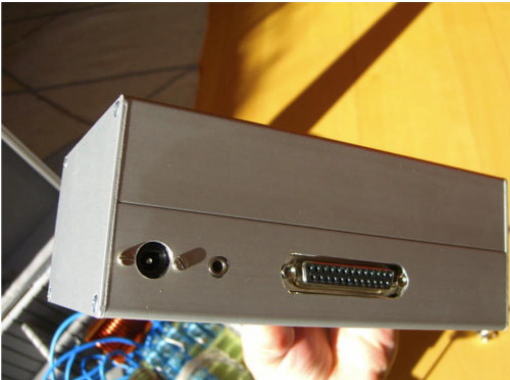
Rückseite, Buchsen von Links nach Rechts: 12V DC - PA Verriegelung - Kopple
