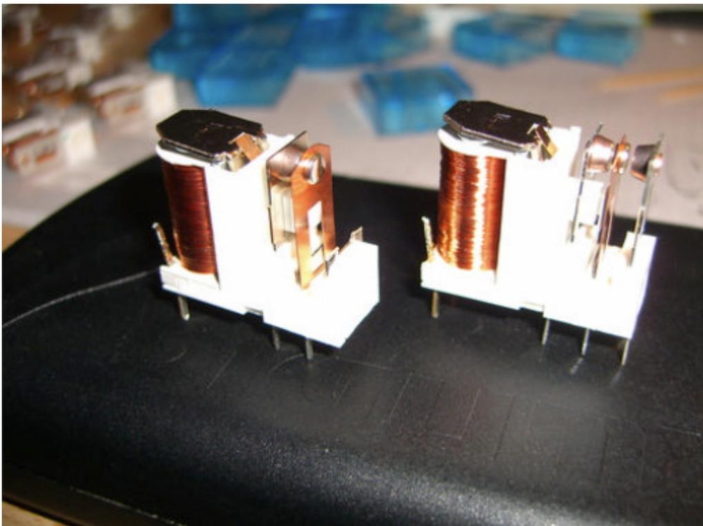
Die L-Relais wurden hinsichtlich des Kontaktdruckes modifiziert. Dazu wurde der Schließkontakt entfernt und der Öffnerkontakt in Richtung Schaltkontakt gebogen
