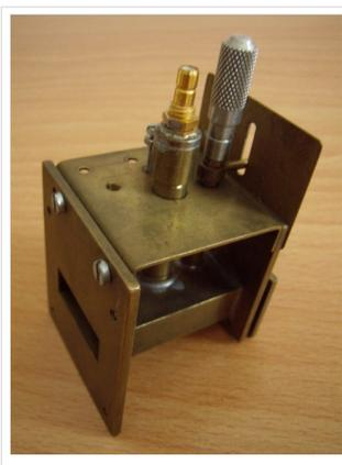
Das Photo links zeigt einen Nachbau nach OE1RVW durchgeführt von OE3JS und OE3WOG aus dem Jahre 1977. Als Hohlleiter wurde ebenfalls Messing Möbelprofil verwendet, anstelle des Fahrradventils zur Kontaktierung der Mischdiode wurde bereits eine SMB Koax Verbindung verwendet.
