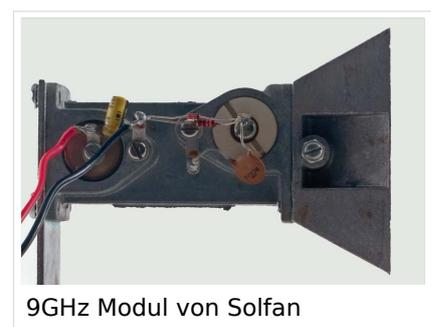
Die mechanische (grobe) Frequenzabstimmung erfolgte über einen Plexiglasstab der über ein Spindel angetrieben in den Hohlleiterresonator eintauchte. Diese Gunn-Plexer Version war noch nicht für eine separate Varaktordiode ausgelegt und war nur mit dem Gunn Element und einer Mischdiode ausgerüstet. Die Feinabstimmung der Arbeitsfrequenz wurde durch geringfügige Veränderungen der GUNN Versorgungsspannung durchgeführt.
