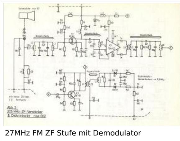
27MHz FM ZF Stufe mit Demodulator
