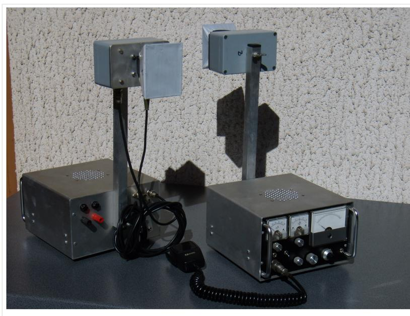
Das Bild links zeigt Front und Rückseite der beiden 3cm Gunnplexer von OE3WRA. Die Antennen sind mit Kunststofffolie gegen Wind und Feuchtigkeit geschützt. Die Antenne ist direkt mit dem MA87127 Gunnplexer verschraubt. Hier wurden bereits Normflansche passend für WR90 vorgesehen was diverse Messungen mit kommerziellen Meßgeräten wesentlich erleichterte. Die Steuerung des Transceivers, ZF Stufe und Modulator befinden sich im unten angebrachten
