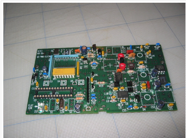
Hauptplatine mit alle niedrigen Teilen
