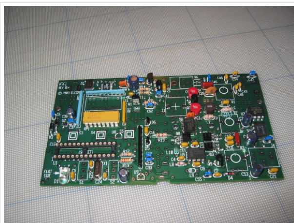
Hauptplatine mit alle niedrigen Teilen
