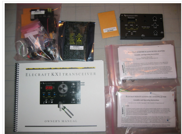
Elecraft KX1, Antennentuner, Banderweiterung
