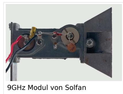
Die mechanische (grobe) Frequenzabstimmung erfolgte über einen Plexiglasstab der über ein Spindel angetrieben in den Hohlleiterresonator eintauchte. Diese Gunn-Plexer Version war noch nicht für eine separate Varaktordiode ausgelegt und war nur mit dem Gunn Element und einer Mischdiode ausgerüstet. Die Feinabstimmung der Arbeitsfrequenz wurde durch geringfügige Veränderungen der GUNN Versorgungsspannung durchgeführt.
