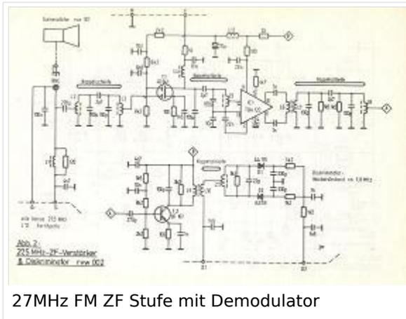
27MHz FM ZF Stufe mit Demodulator
