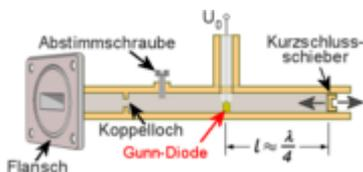
Der Aufbau des GUNN Elements besteht aus hintereinander geschalteten unterschiedlich dotierten Materialien, wie Galliumnitrid bzw. Indiumphosphid. Diese Materialien stellen eine Elektronenfalle dar, es entsteht eine Art negativer Widerstand, die Elektronen werden gestaut und wandern in Schüben durch das Element.
