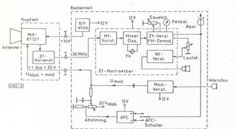
Abb. 2. 10-GHz-Transceiver, Blockschaltbild
