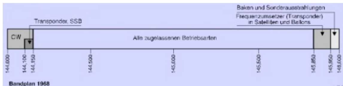
Bandplan für das 2 Meter Band 1968
